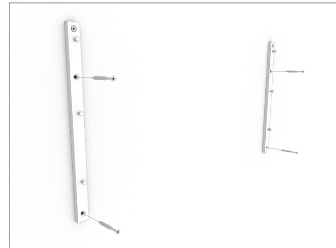
**6** Bohre die restlichen Löcher (Du kannst die Leisten dazu an der oberen Schraube hängen lassen und zur Seite schieben) und schraube die Leisten fest. Vergiss nicht, auch die obersten Schrauben noch einmal festzuziehen.
